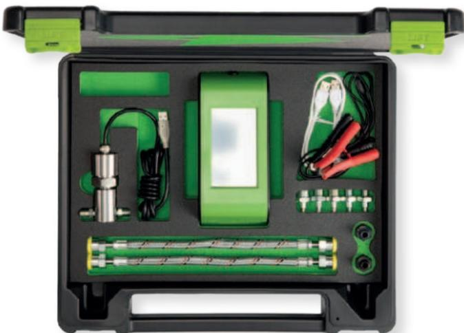
TESTER MULTI-FUNZIONE PER PROVA COMPRESIONE E PROVA PRESSIONE CARBURANTI
